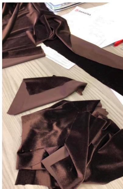
Preparazione dei provini in velluto sintetico, di superficie 20x20 cm (400 cm<sup>2</sup>)
