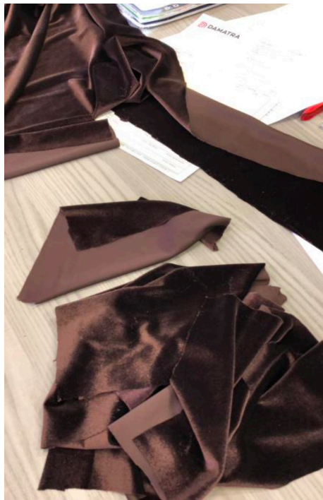
Preparazione dei provini in velluto sintetico, di superficie 20x20 cm (400 cm 2 ) Grammatura velluto 235 g/m 2 verificata
