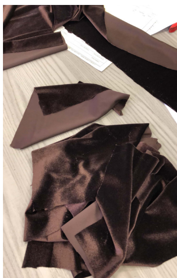
Preparazione dei provini in velluto sintetico, di superficie 20x20cm (400cm 2 ). Grammatatura velluto 235 g/m 2 verificata.
